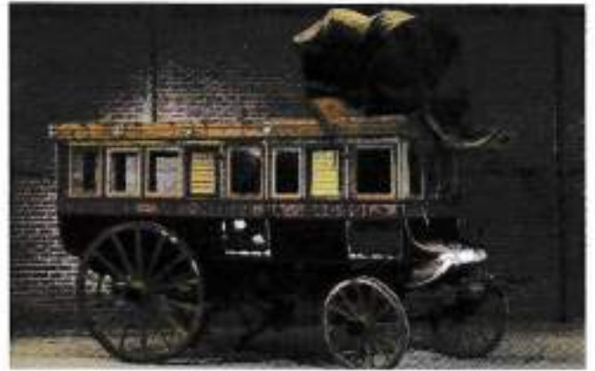
Diligence du XIX ème siècle (en Lozère). Construite en tôle, cette voiture de 4,50 m de long et 3,10 m de large compte trois compartiments pour les passagers et une place au-dessus du wagon pour le cocher. Alors que la plupart des véhicules de ce type ont été détruits avec l'apparition de l'automobile..., «cette diligence est exceptionnelle par sa rareté.»
